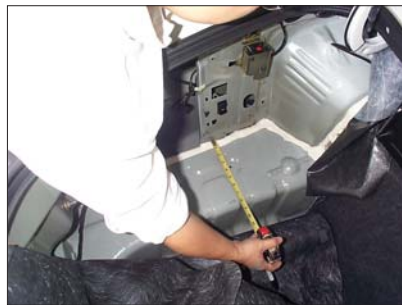
วัดจากขอบ หลังจากทำเครื่องหมายที่วัด จากรู 5-3/4" ออกมา 3-7/8" และใช้สว่าน เจาะเหล็กขนาด 17/64 เจาะรู
