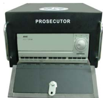
รูปที่ 6 : DVR ติดตั้งภายใน Vault
