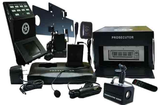
รูปที่ 1 : ระบบบันทึกภาพและเสียงในรถยนต์ ( Prosecutor System)
